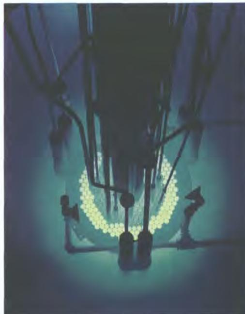
Исследовательский реактор в Японии используется для изучения происходящих в топливе процессов; работа проводится в рамках исследований ядерной безопасности. (Фото: JAERI)
