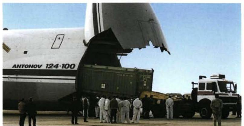
aux châteaux de transport, on a utilisé un type de conteneur fourni par NAC, muni d'un bouclier en plomb de 13,2 centimètres d'épaisseur et d'un clapet de fond. Sa partie inférieure était conçue pour s'adapter soit à un guide en plomb pour le positionnement sur un bassin de stockage, soit à un chariot quand il était utilisé à la station de nettoyage et au niveau du château de transport.
