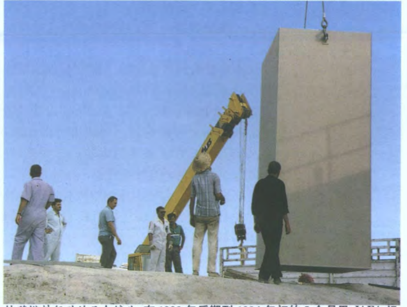
转移燃料行动的几个镜头：在 1993 年后期到 1994 年初的 5 个月里，IAEA 组织并监督了从伊拉克的图韦查核研究中心和附近的贮存地运走已申报的所有核武器级材料的工作。总计有 208 个乏燃料组件形式的高浓铀被回收、清洗、装入重量达 23 吨的运输容器、加封记并运出伊拉克。共有 170 名工作人员参加了这一行动，包括伊拉克的工作人员、IAEA 专家以及美国和俄罗斯的承包商。这里展示的是这项既复杂、技术要求又很高的行动的一些镜头。（来源：R. Ouvrard, IAEA；伊拉克原子能委员会）
