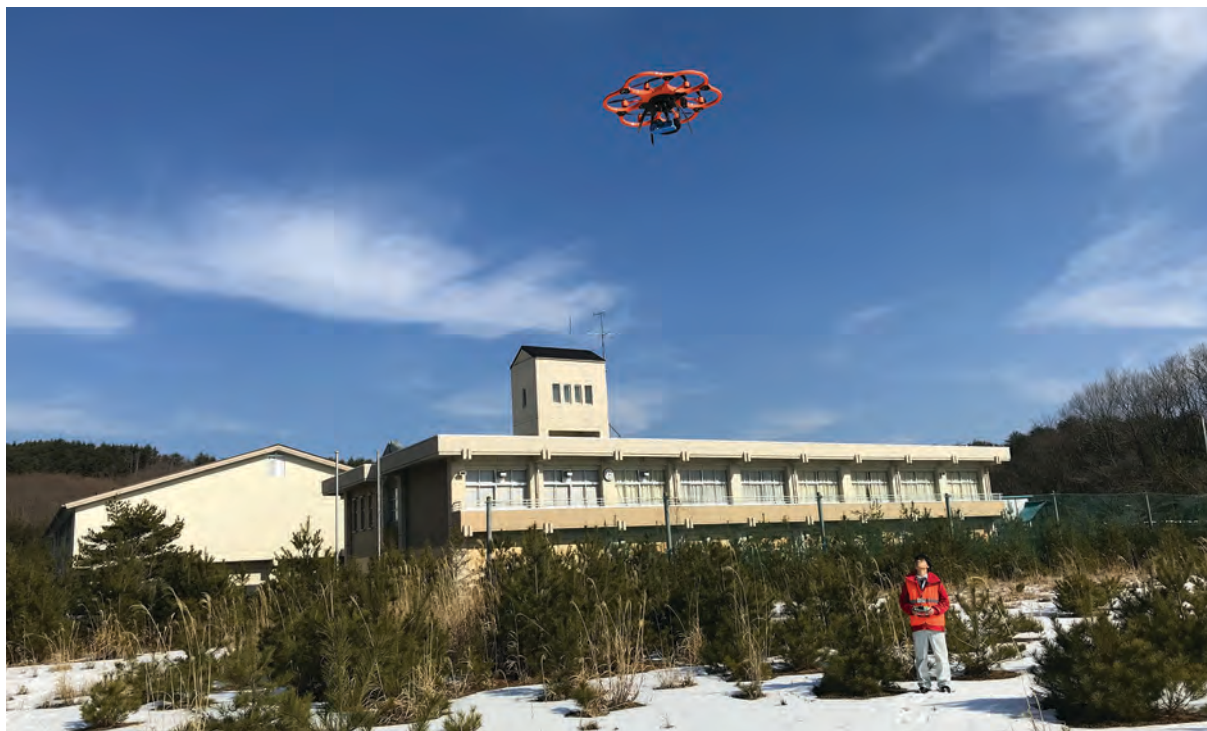
图3. 原子能机构开发了一种使用无人机的新技术，供日本福岛县当局使用，可以进行放射性测量。（照片由福岛县提供。）
