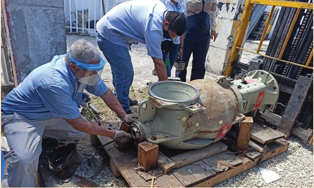
الخبراء يفككون رأس جهاز للعلاج الإشعاعي الخارجي كان يُستخدم في توفير الرعاية للمصابين بالسرطان في كولومبيا، تمهيداً لإيداعه قيد الخزن المأمون والأمن.
