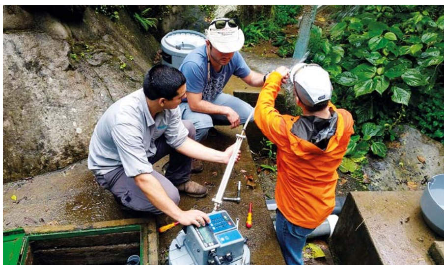
Fig. 1. Capacitación sobre el terreno en Costa Rica en la que se utilizan muestras de agua subterránea para analizar isótopos de gases nobles.
