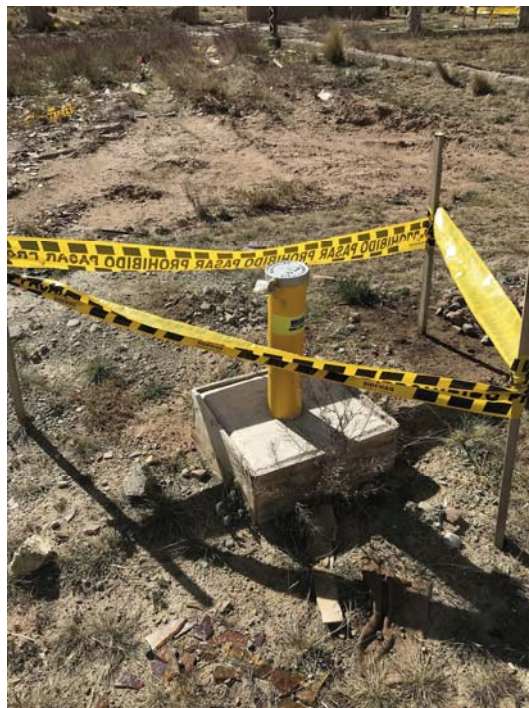
Fig. 1. Una de las varias perforaciones geológicas realizadas como parte de la caracterización del emplazamiento para el nuevo reactor de investigación de 200 kW en El Alto (Estado Plurinacional de Bolivia).
