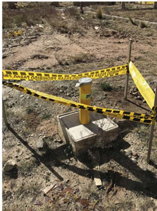
图 1. 作为多民族玻利维亚国埃尔阿托新建 200 千瓦研究堆场址表征的一部分进行的数个地质钻探之一。
