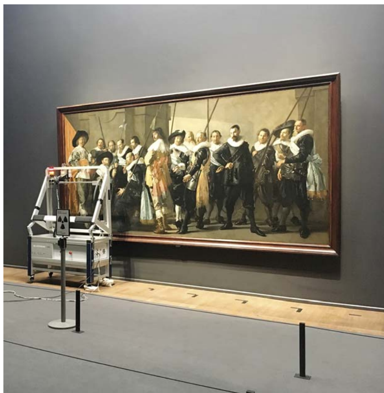
图 3. 正在用宏观 X 射线荧光分析在荷兰阿姆斯特丹国立博物馆展出的弗朗斯·哈尔斯的绘画。（照片由国立博物馆提供。）
