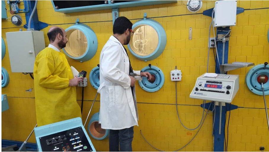
الشكل ١- عضو فريق خدمة تقييم وقاية العاملين من الإشعاعات يرصد عملية إنتاج اليود-١٣١ خلال بعثة إلى مركز لو أجيري للبحوث النووية التابع للجنة الطاقة النووية الشيلية في شيلي.
