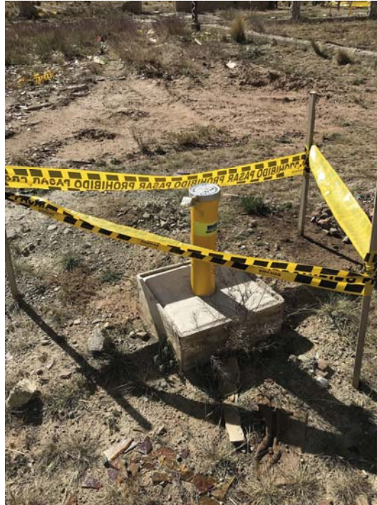
الشكل-١- إحدى آلات الحفر الجيولوجي التي شُيِّدت في سياق عمليات تحديد خصائص المواقع من أجل تشييد مفاعل بحوث جديد بقدرة ٢٠٠ كيلواط في إل ألتو، دولة بوليفيا المتعددة القوميات.
