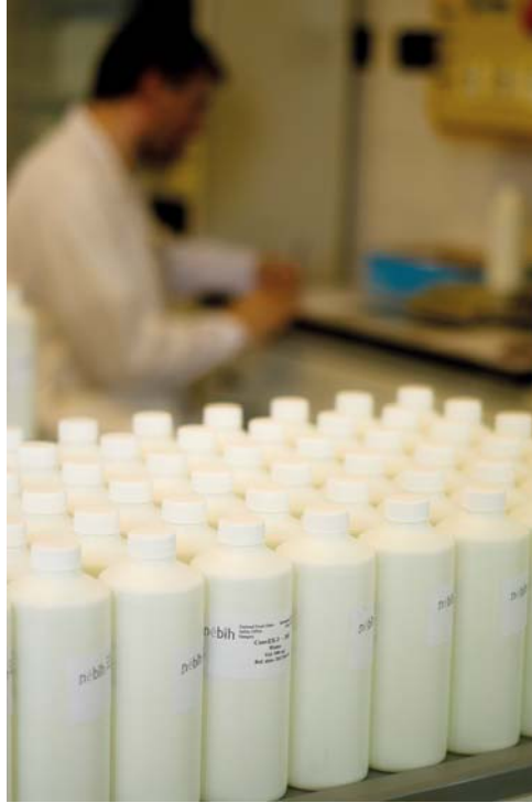
الشكل-١- اختبارات مخبرية لعينات مياه تحتوي على نويدات مشعة عادة ما توجد في البيئة عقب وقوع حادث نووي، أجريت في إطار تمارين ConvEx3 في حزيران/يونيه.
