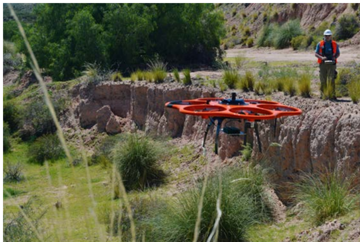
Fig. 2. El sistema del Organismo de aeronaves no tripuladas para una monitorización medioambiental rápida incluye drones equipados con sensores y cámaras que permiten recopilar a distancia datos para la rehabilitación ambiental.
