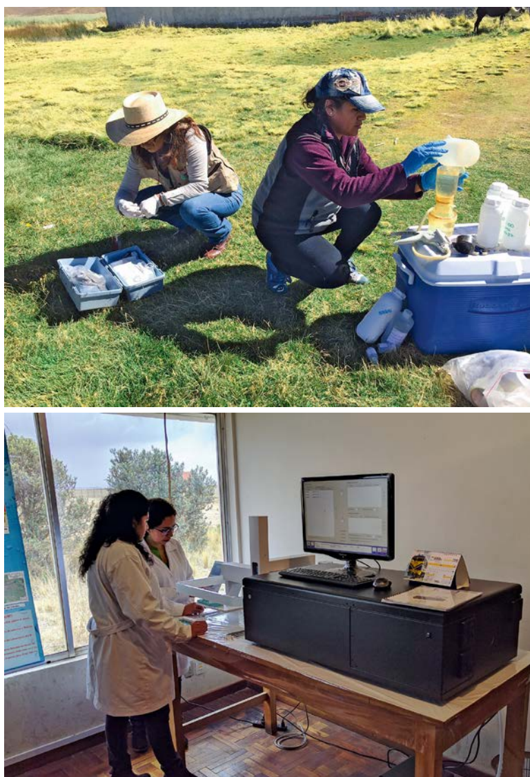
Fig. 1. En el marco de un proyecto de cooperación técnica, contrapartes de Bolivia recogen muestras de agua subterránea sobre el terreno (imagen superior), que después se analizan para medir la relación isotópica por medio de un analizador láser provisto por el Organismo (imagen inferior).
