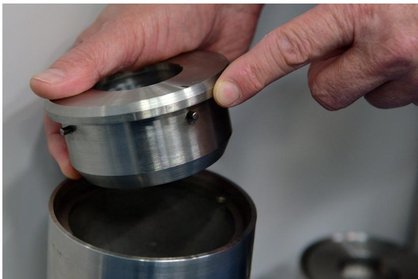
*РИС. 1. Специально разработанный пенал или упаковка для захоронения, предназначенный для скважинного захоронения изъятых из употребления закрытых радиоактивных источников.*
