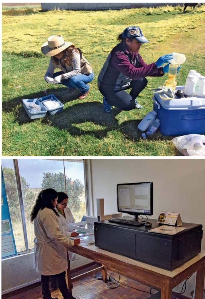
*РИС. 1. В рамках проекта технического сотрудничества боливийские коллеги проводят отбор проб подземных вод в полевых условиях (вверху), которые затем анализируются с целью определения соотношений изотопов с применением лазерного анализатора, предоставленного Агентством (внизу).*
