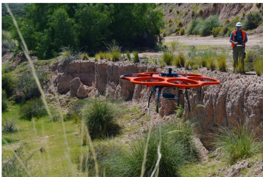
*РИС. 2. Дроны, являющиеся частью системы беспилотных летательных аппаратов Агентства для оперативного мониторинга окружающей среды, оборудованы датчиками и камерами и используются для дистанционного сбора данных при подготовке к экологической реабилитации.*
