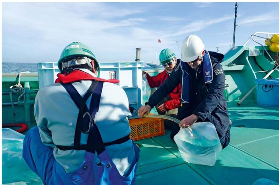
*РИС. 3. Начиная с 2014 года производился регулярный отбор проб морской воды на пяти станциях в радиусе 10 км от АЭС "Фукусима-дайити" для межлабораторного сравнения результатов анализа, полученных в японских лабораториях и Лаборатории окружающей среды МАГАТЭ в Монако. В 2016 году было также организовано проведение межлабораторного сравнения измерений радионуклидов в пробах отложений и рыбы, отобранных в этом же районе.*
