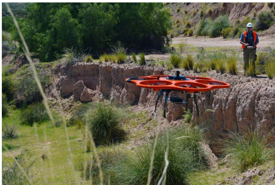
FIG. 2. Le système de drones mis au point par l'Agence pour le contrôle radiologique rapide de l'environnement se compose de drones dotés de capteurs et de caméras embarqués. Pilotés à distance, les drones recueillent des données en vue de la remédiation de l'environnement.
