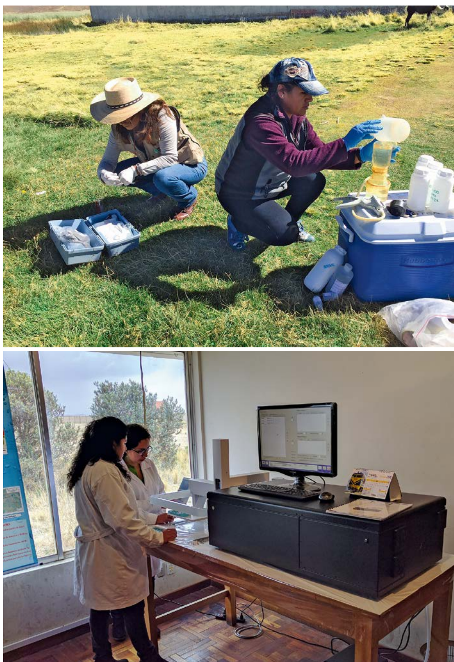
FIG. 1. Dans le cadre d'un projet de coopération technique, les contreparties de projet boliviennes prélèvent des échantillons d'eaux souterraines sur le terrain (en haut), qui sont ensuite analysés à l'aide d'un analyseur laser fourni par l'Agence (en bas) pour en déterminer les rapports isotopiques.
