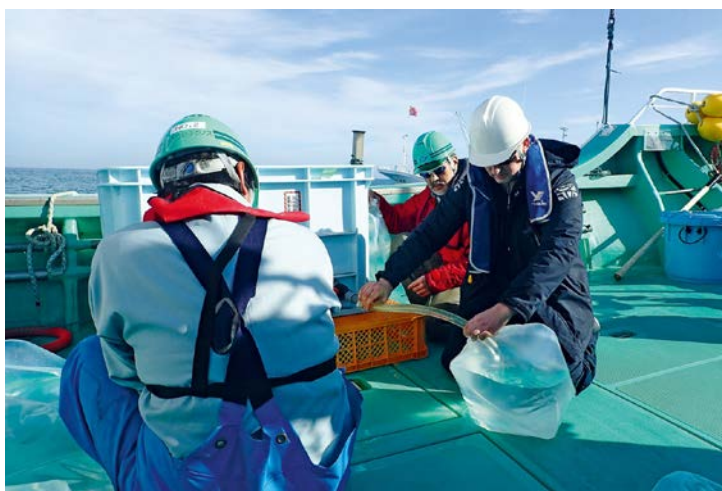
FIG. 3. Des échantillons d'eau de mer prélevés dans cinq stations situées dans un rayon de 10 km de la centrale nucléaire de Fukushima Daiichi ont été collectés régulièrement depuis 2014 aux fins de comparaisons interlaboratoires entre des laboratoires japonais et les Laboratoires de l'environnement de l'AIEA à Monaco. En 2016, des comparaisons interlaboratoires ont été aussi organisées pour détecter la présence de radionucléides dans des sédiments et des poissons collectés dans la même région.
