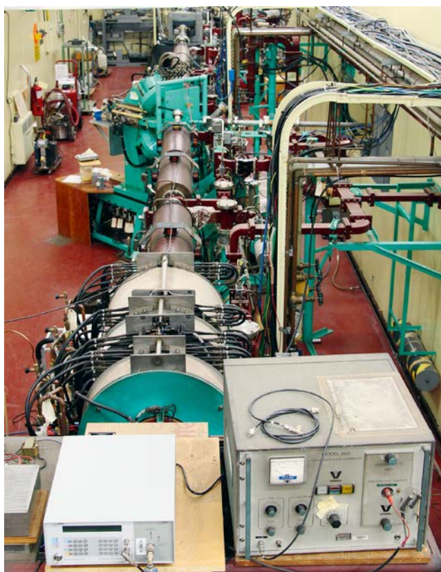
FIG. 1. Accélérateur linéaire utilisé pour produire du molybdène 99 à partir de molybdène 100 grâce au procédé de capture neutronique. (Photo : R. Galea, Conseil national de recherches Canada ; Canadian Crown Copyright.)
