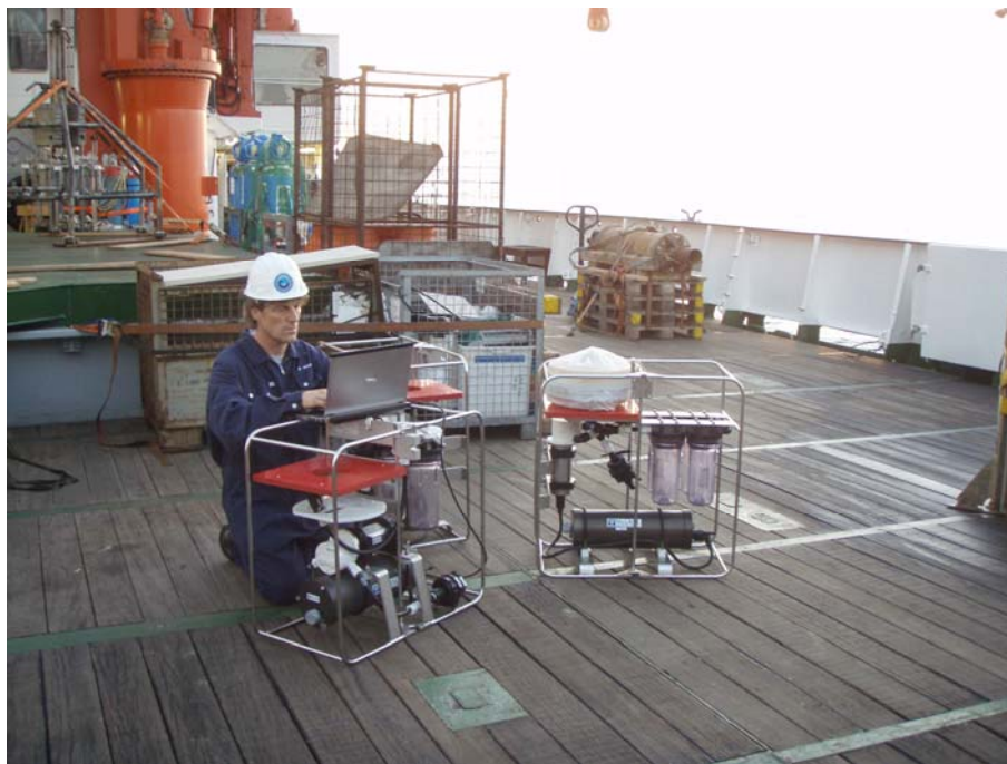
Рис. 3. Сотрудник Агентства программирует погружные насосы для отбора проб воды и частиц в море вблизи перуанского побережья с целью оценки экспорта углерода.
