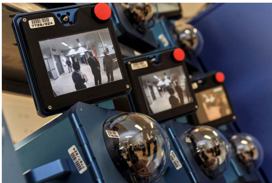
Рис. 2. Испытания камер системы наблюдения следующего поколения (СНСП), предшествующие их монтажу на ядерных установках.
