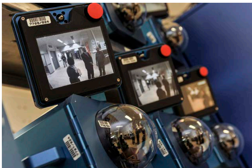
FIG. 2. Les caméras du système de surveillance de la prochaine génération (NGSS) sont testées avant leur mise en place dans les installations nucléaires.
