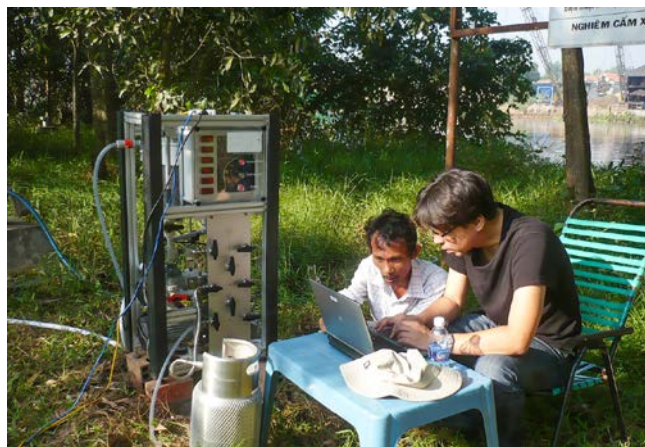
FIG. 1. Prélèvement d'échantillons de krypton 81 et de gaz rares pour la datation des eaux souterraines profondes dans l'aquifère du delta du Mékong dans le sud du Viet Nam.
