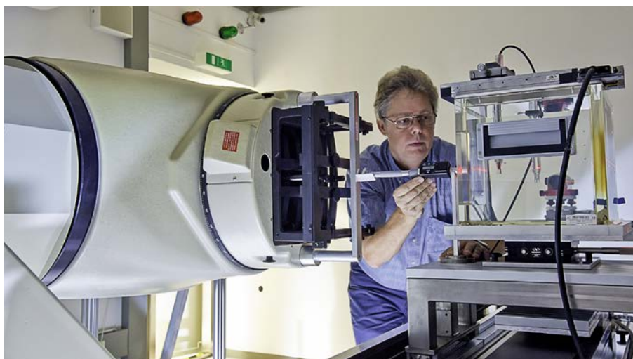
FIG. 1. Mesure d'étalonnage des étalons de référence de la dosimétrie des rayonnements au Laboratoire de dosimétrie de l'AIEA.
