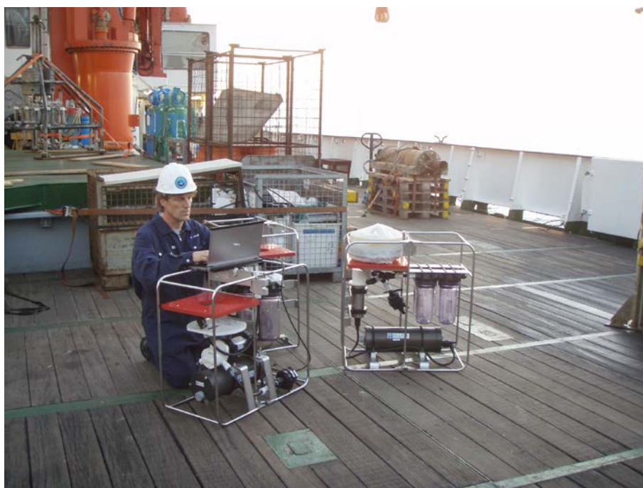
FIG. 3. Un fonctionnaire de l'Agence programme des pompes in situ afin de prélever des échantillons d'eau et de particules au large de la côte péruvienne pour évaluer le transfert de carbone.
