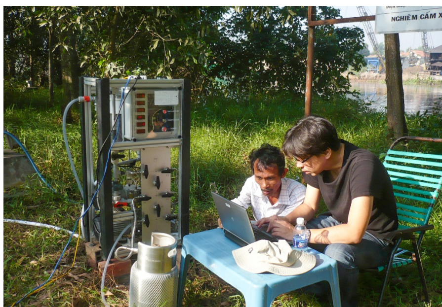
图1. 在越南南部对湄公河三角洲含水层的深层地下水进行了氙-81和惰性气体测龄采样。
