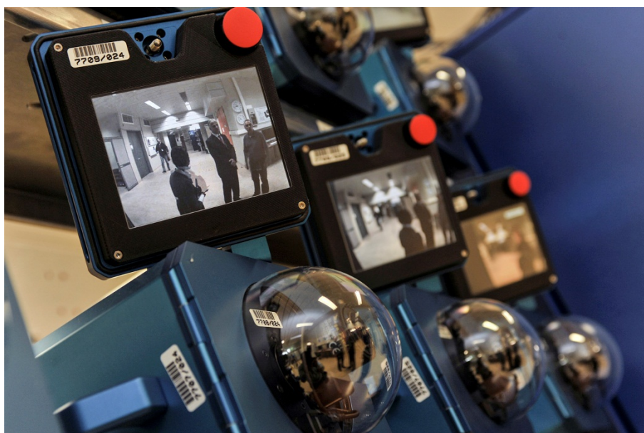
图 2. 在核设施安装之前对下一代监视系统摄像机进行测试。
