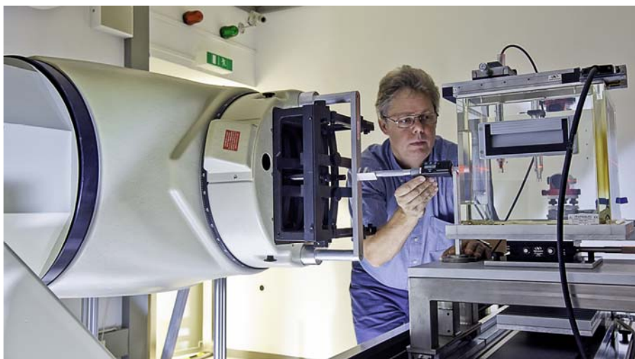
图 1. 原子能机构剂量学实验室剂量测定参考标准的校准测量。
