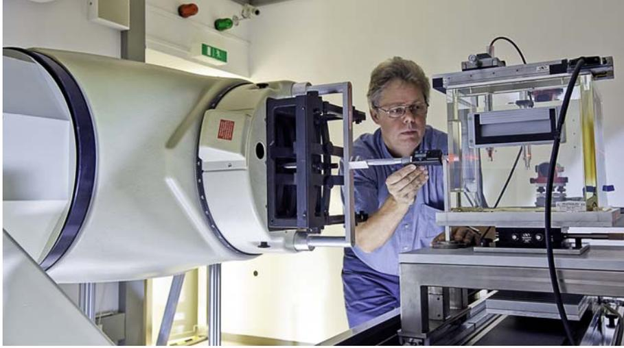
الشكل ١ - قياس المعايرة للمعايير المرجعية لتحديد الجرعات في مختبر قياس الجرعات التابع للوكالة
