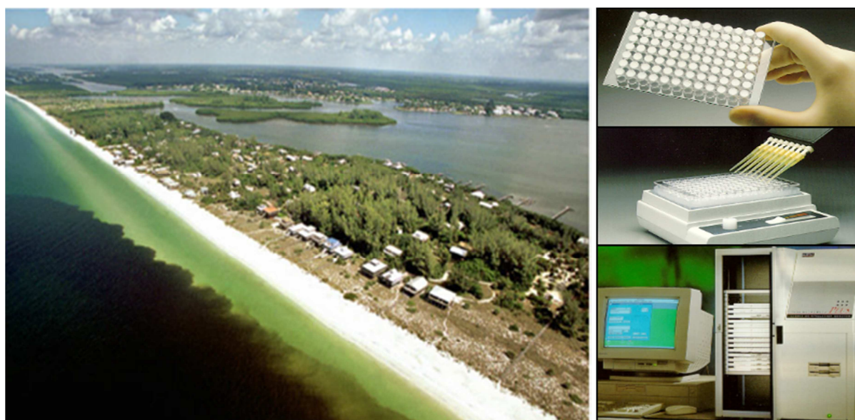
FIG. 1. Exemple de prolifération d'algues toxiques (à gauche) (photo : B. Suarez). La technique de dosage par radioligand permet de détecter les proliférations d'algues toxiques à un stade précoce (à droite).
