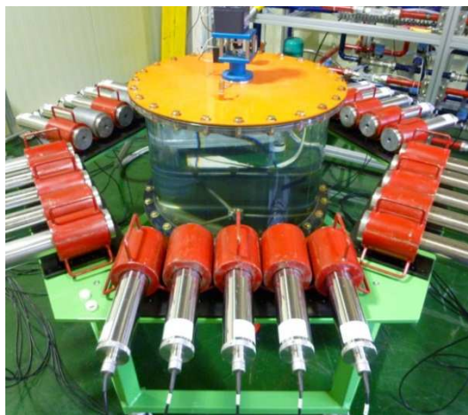
FIG. 3. Système industriel de tomographie informatisée d'émission monophotonique pour la visualisation à l'aide des radiotraceurs ^{68}\text{Ga} et ^{137\text{m}}\text{Ba} produits par générateurs.
