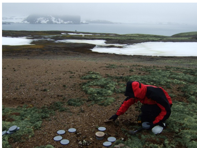
FIG. 7. Prélèvement d'échantillons de terre en Antarctique (île Ardley) en vue de l'analyse des radionucléides provenant de retombées pour l'évaluation de l'impact du changement climatique sur la redistribution des terres.
