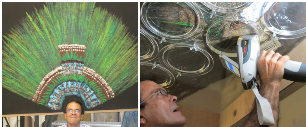
FIG. 5. Coiffe mexicaine du XVI e siècle (à gauche) examinée à l'aide d'un spectromètre portatif à fluorescence X (à droite).
