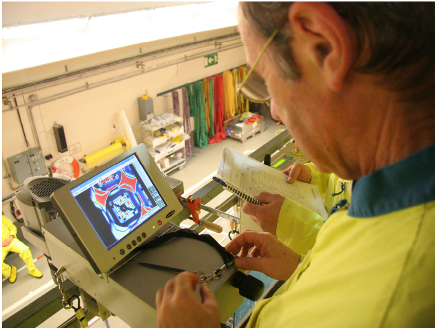
الشكل ٢ - التحقق من القود المستنفد باستخدام جهاز رقمي لرؤية ظاهرة تشيرينكوف
