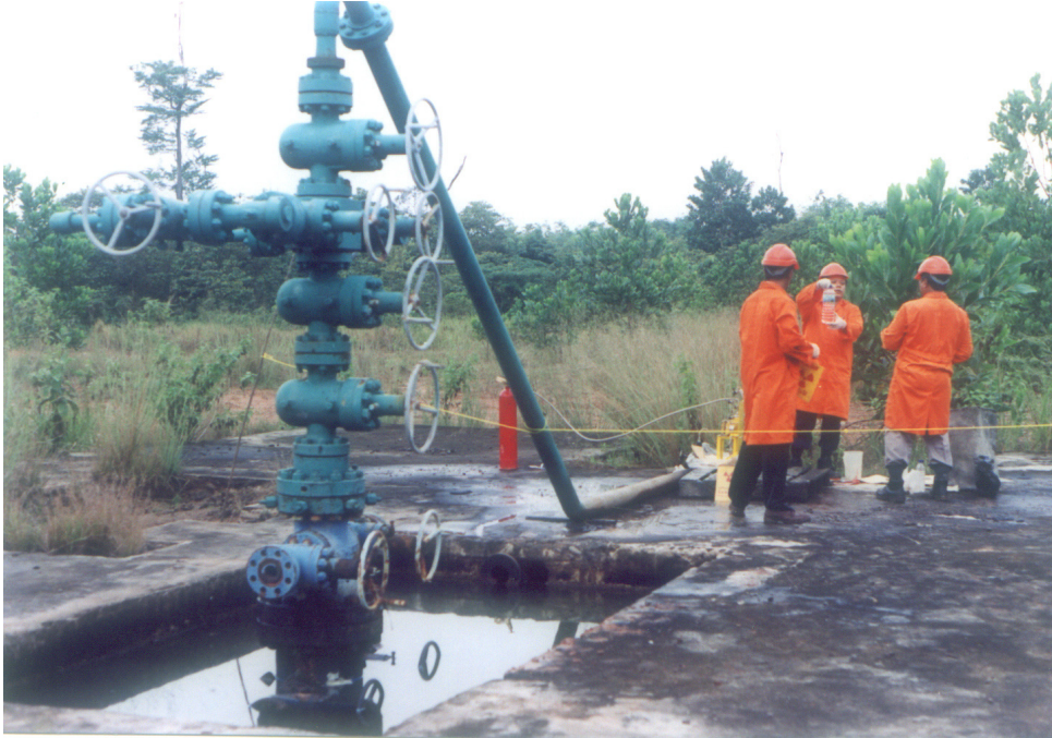
الشكل ١. حقن المياه المعالجة بالترينيوم كوسيلة اقتفاء لدراسة الحركة بين الآبار في حقل نفط في إندونيسيا.
