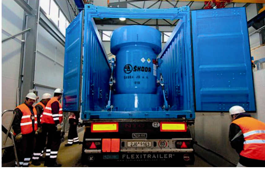
الشكل ٢ - برمبل نو سعة عالية يُستخدم في شحن الوقود المستهلك من ريز، بالجمهورية التشيكية.
