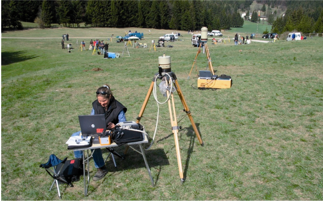
الشكل ٢ - نظم لقياس طيف أشعة غاما ذات قدرة تحليلية عالية جداً يجري اختبارها تحت ظروف ميدانية خلال التدريب على سيناريو المقارنة في الموقع بالنمسا.
