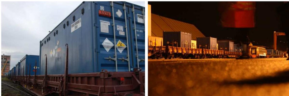
*РИС. 1. Два фотоснимка транспортных контейнеров с отработавшими твэлами, содержащими ВОУ и НОУ, в процессе перевозки с исследовательского реактора RA в Институте ядерных наук "Винча", Сербия, в Российскую Федерацию.*
