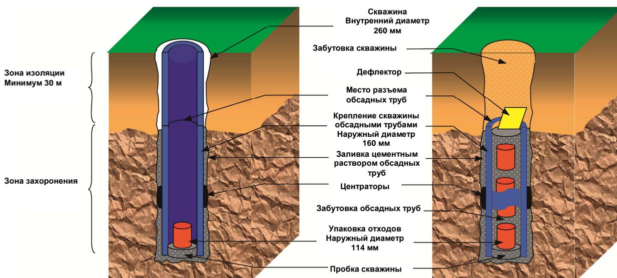
РИС. 1. Схематическое изображение концепции захоронения в скважине.
