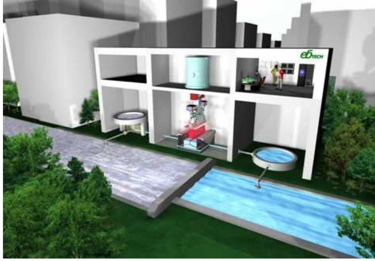
الشكل ٢ - معالجة مياه الصرف الصحي بالحزم الإلكترونية (الصورة مهداة من ب. هان، إبتك).
