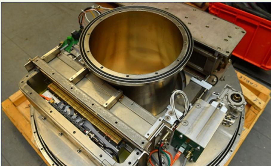
用于核实乏核燃料的非能动 $\gamma$ 发射断层照相工具内部组件。
