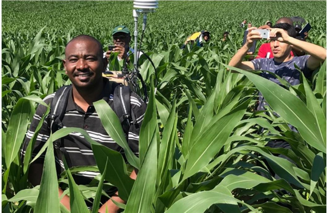
宇宙射线中子传感器可帮助农民测量土壤中的水分含量。
