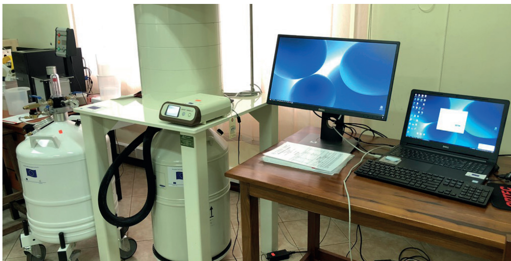
Урановая лаборатория оснащена, помимо прочего, системой гамма-спектрометрии, с помощью которой власти смогут проводить надлежащую оценку урана, добытого в стране.
