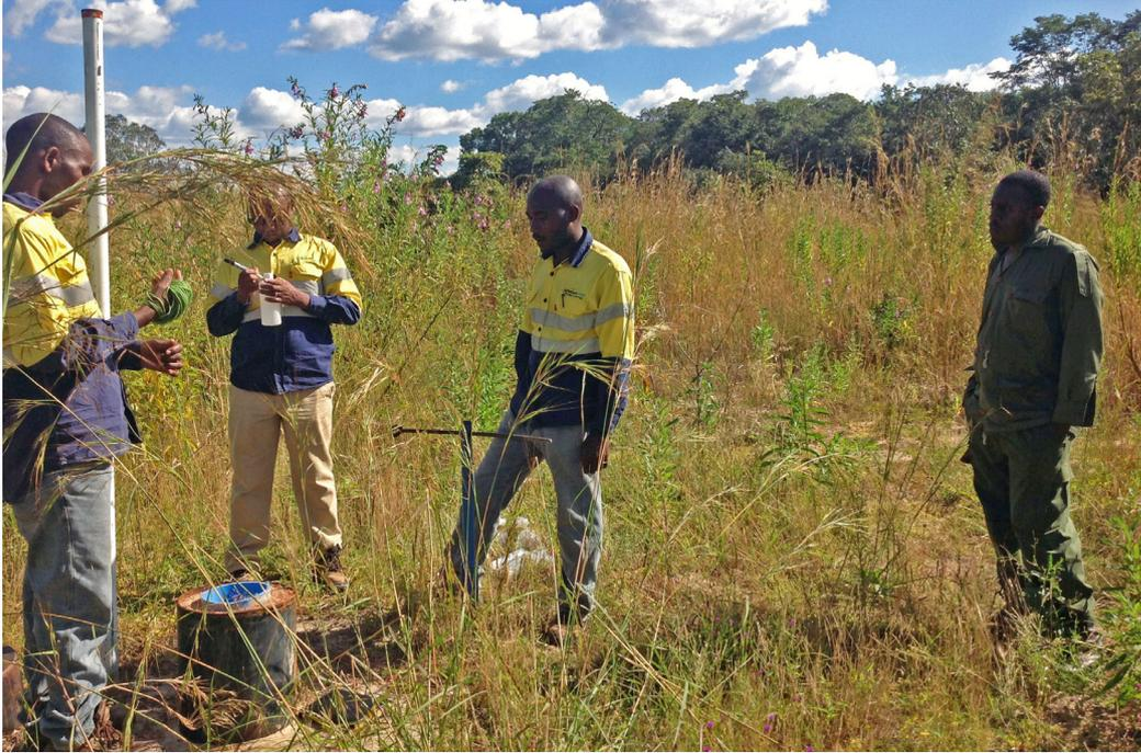
**Prélèvement d'échantillons de l'environnement dans la rivière Mkuju en vue de mesurer le rayonnement de fond avant le début de l'extraction.**
