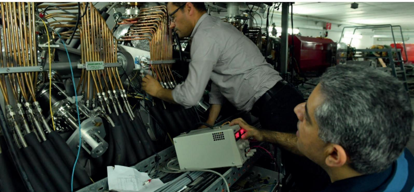
**9** Operarios comprueban el suministro de energía eléctrica en el anillo de almacenamiento externo de la instalación.
