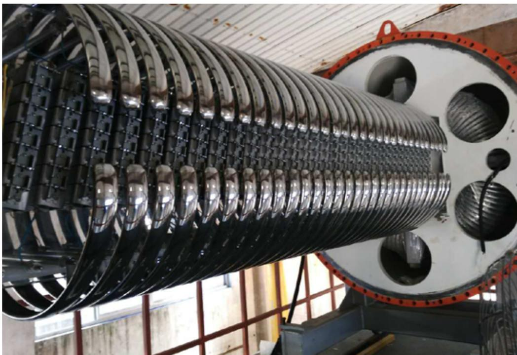
将电子束技术用于处理金华市纺织印染厂的工业废水。
