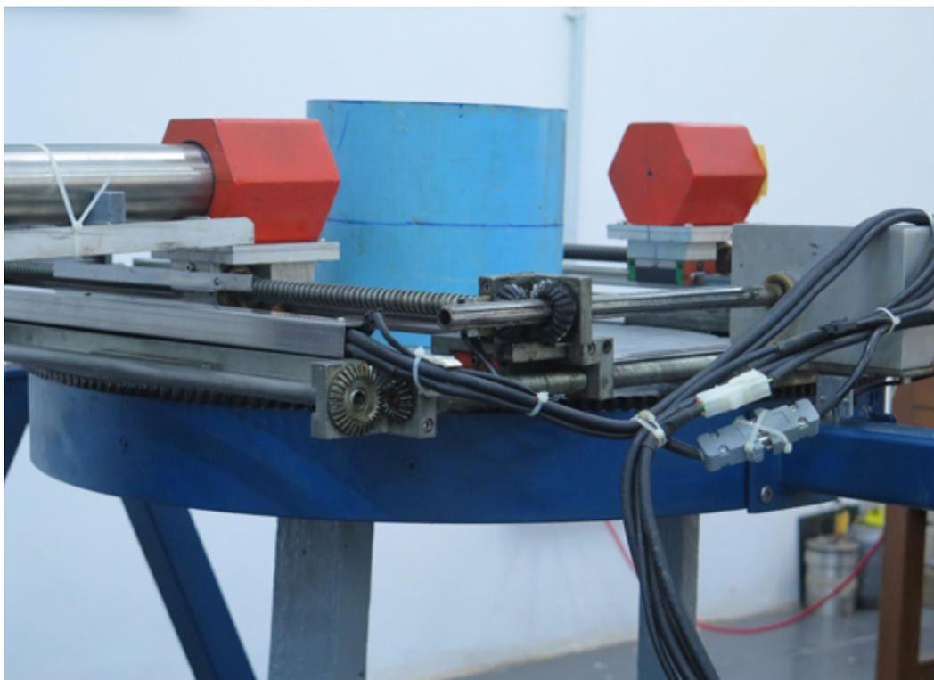
此无损检测装置从放射源发射辐射（左）。放射性粒子与中间浅蓝色管中物质发生反应。管子另一侧上的探测器测量辐射。此测量提供有关通过管道材料的质量和数量的信息。
