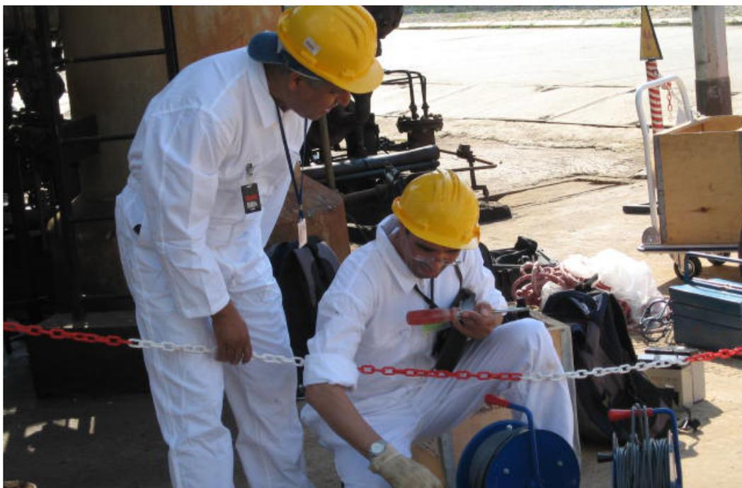
辐射技术可用于检查工艺过程的内部构件或设备的零件，而不必中断生产。
