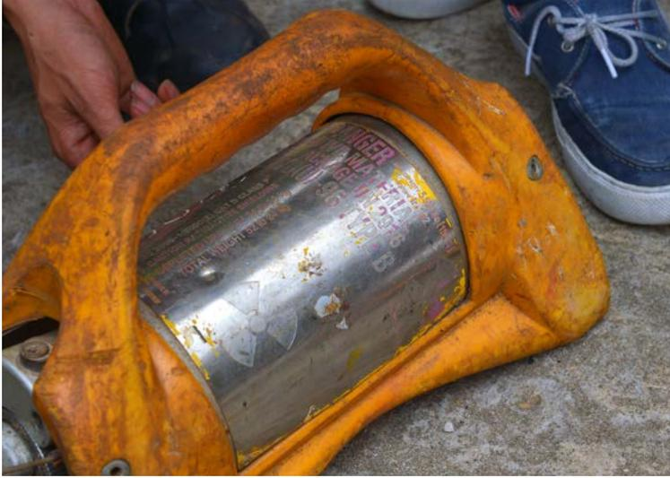
٢ مثلما أن الأشعة السينية تُستخدم للتثبُّت من وجود كسر في العظام، تُستخدم أجهزة التصوير الإشعاعي الصناعي للتثبُّت من وجود شقوق أو عيوب في المكونات الصناعية. وتتضمن هذه الأجهزة مصادر مشعة وهي محمولة، ما يجعلها عرضة لفقدانها أو سرقتها. وسنوياً تُبلغ الوكالة الدولية للطاقة الذرية بحالات فقدان أو سرقة مصادر مشعة.
