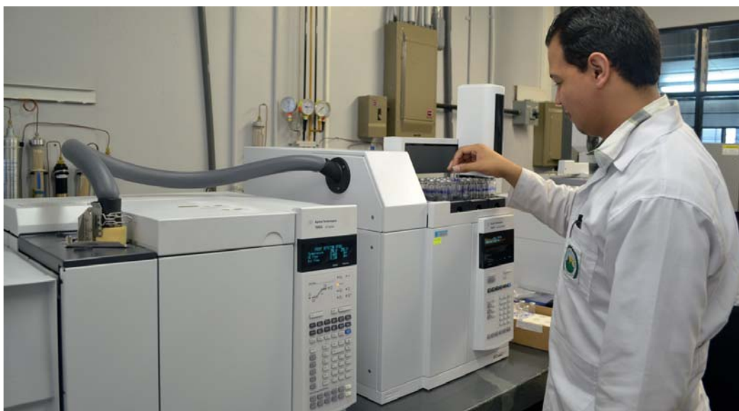
Анализ отобранных на местах проб с помощью газового хроматографа с парофазным пробоотборником.
