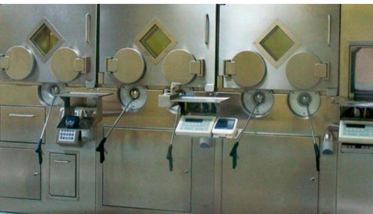
**Недавно созданная установка по производству радиофармацевтических препаратов на базе Y-90 располагает отвечающими требованиям надлежащей производственной практики горячими камерами, которые обеспечивают защиту работников и производство высококачественных препаратов.**
