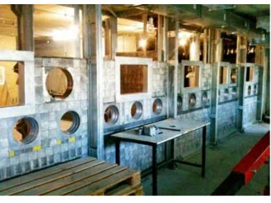
生产锝-99m和碘-131放射性药物的热室由铅玻璃窗 和用于安装遥控机械手的联锁架构成。原子能机构 提供所用的这些铅玻璃窗和遥控机械手,它们由技 术人员和智利核能委员会(CCHEN)的工作人员 在一起安装。
