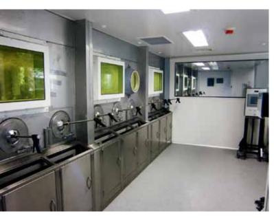
用于生产锝-99m的新热室符合相关良好生产规范要 求。热室的外部由不锈钢制成,热室的墙、地板和 天花板符合所要求的药品纯度。
