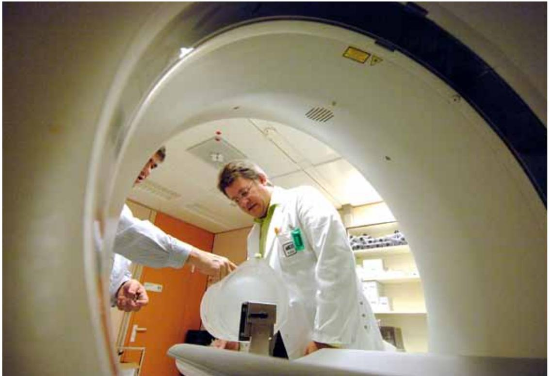
医学物理师为测量诊断造影仪的输出准备头模（头的模型）。
