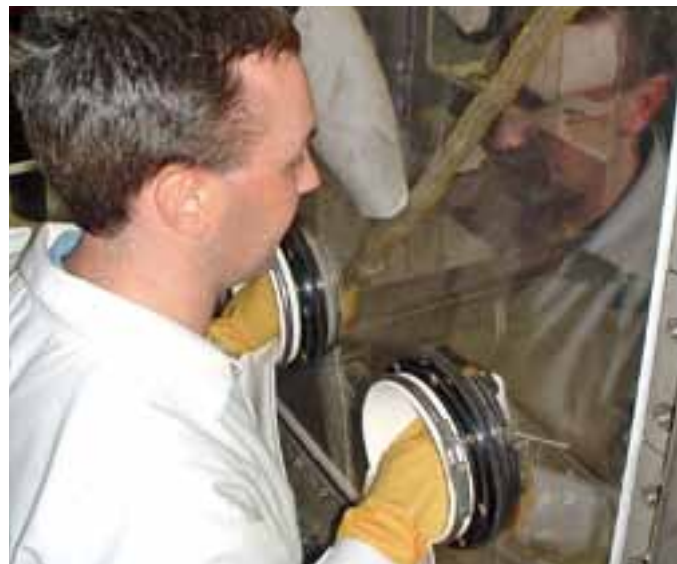
废物分离用的分拣手套箱 (图/敦雷场址恢复有限公司和英国核退役管理局)
