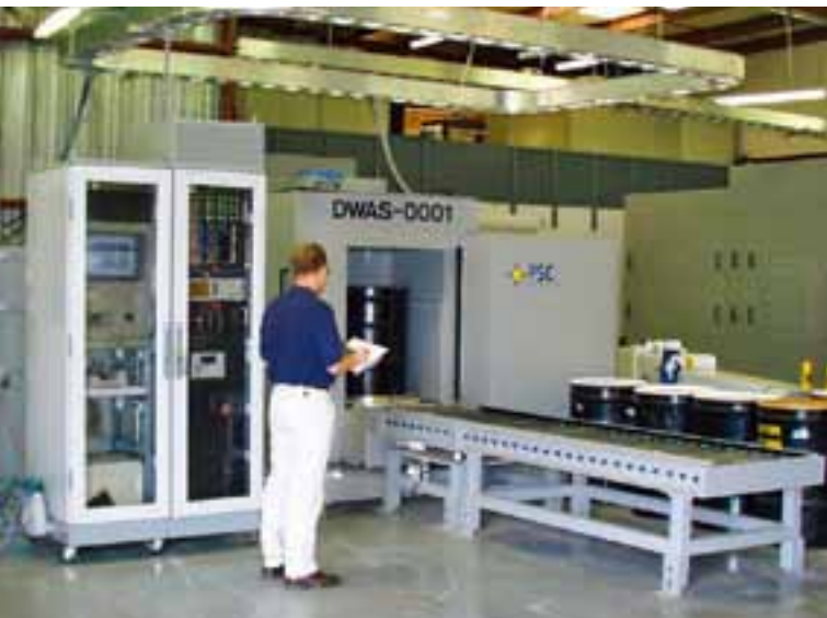
无源-有源中子微分衰减系统(PANDDA™)，废物桶监测高分辨率γ能谱系统 (图/美国Pajarito科学公司)
