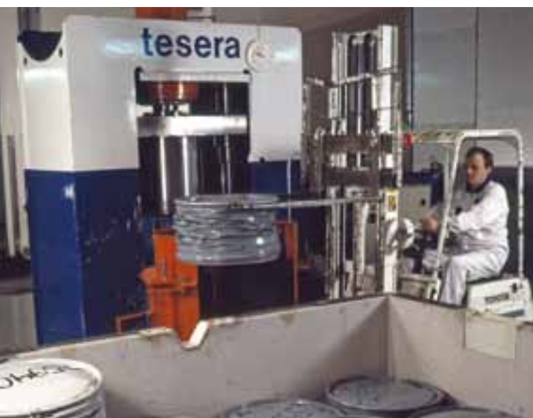
固体废物桶超级压缩机 (图/芬兰发电公司)
