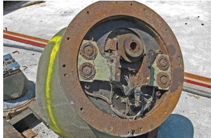
(À droite) Une source retirée du service, rouillée, avant son conditionnement.
