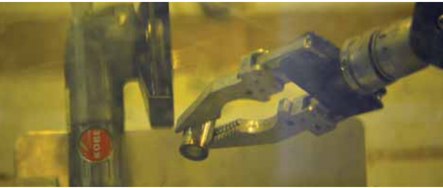
工作小组成功地从医疗装置中取下源。(照片由国际原子能机构帕夫利切克提供)
