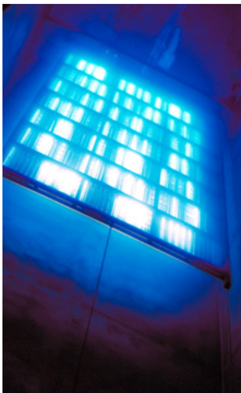
钴-60 \gamma 辐照器被用于包装等产品中所使用材料的处理和消毒。 (图/加拿大Nordion公司)
