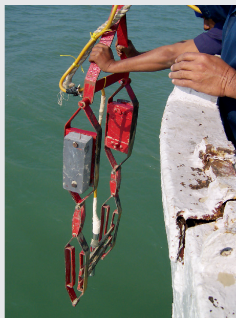
Мониторинг после введения радиоактивного индикатора в рамках исследования переноса отложений в порту Калькутты, Индия, в 2016 году. Фото: Центр атомных исследований им. Бхабхи
