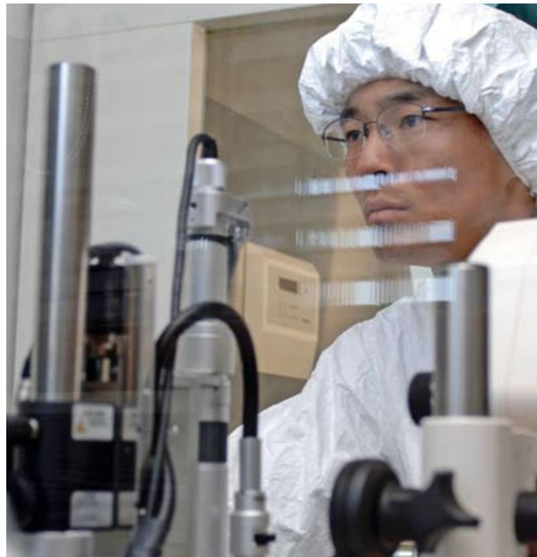
保障环境取样已经变成国际保障的柱石。图中，国际原子能机构在奥地利塞伯斯多夫保障清洁实验室的一名技术人员在用光学显微镜检查铀粒子。
