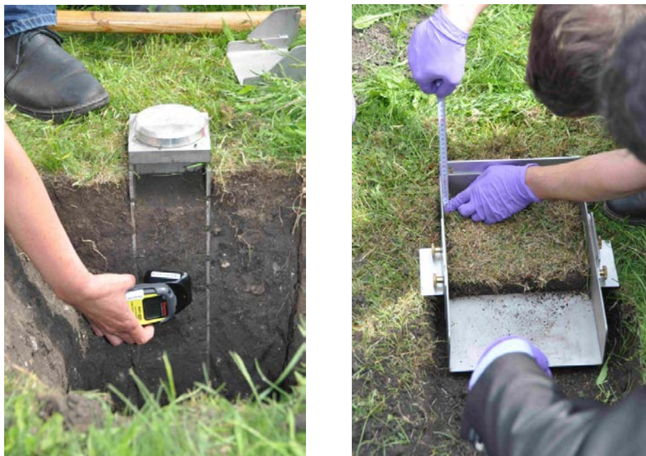
FIG. 3. Formation aux techniques d'échantillonnage du sol pour l'analyse de radionucléides dans l'environnement.
