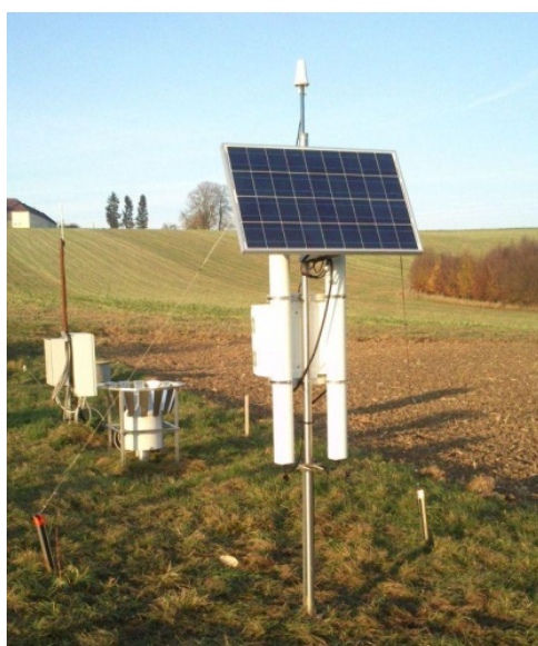
FIG. 2. Système d'observation de l'humidité des sols par rayons cosmiques à Petzenkirchen (Autriche).
