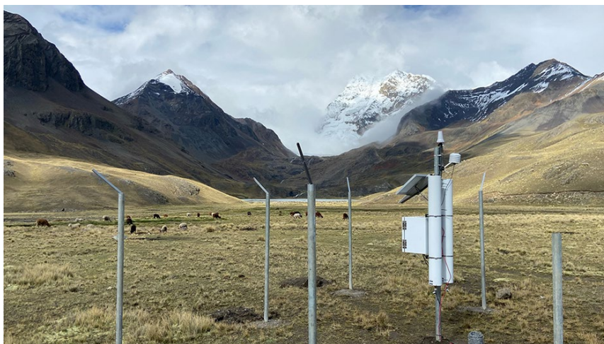
РИС. I.4. CRNS, установленный в боливийских Андах в высокогорных водно-болотных угодьях для изучения их роли в удержании воды в условиях изменения климата (фото: Т. Франц, Университет Небраски в Линкольне).
