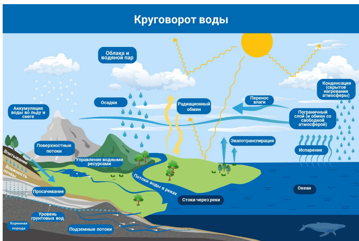
Рис. К.1. Гидрологический цикл (иллюстрация: МАГАТЭ).
