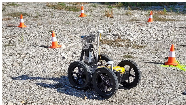
الشكل-هـ-6- استخدام مركبة أرضية غير مأهولة مجهزة في حلقة عمل تدريبية في مختبر العلوم والأجهزة النووية في زايبيرسدورف بالنمسا (يساراً) إلى جانب خريطة الإشعاع التي تبين "المناطق الساخنة" (يميناً). CPS. ترمز إلى العدد في الثانية. (المصدر: الوكالة)
