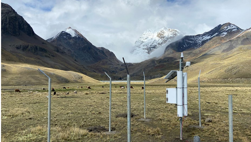
الشكل-طاء-4: جهاز استشعار نيوتروني للأشعة الكونية مثبت في الأراضي الرطبة في بوليفيا في جبال الأنديز على ارتفاعات عالية لدراسة دورها في تخزين المياه في ظل تغير المناخ. (الصورة من: ترنتون فرانز، جامعة نبراسكا - لينكولن)
