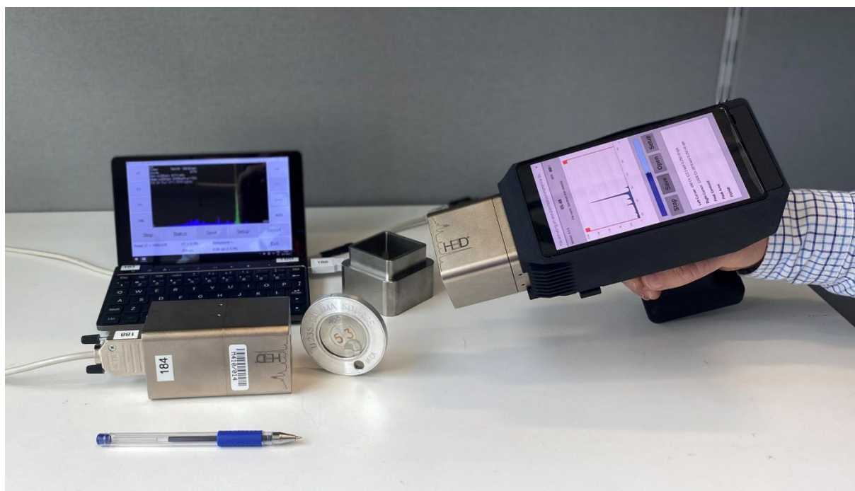
La prochaine génération d'instruments de spectrométrie gamma de l'AIEA : module de détection au tellure de cadmium-zinc (à gauche) et HM6- (à droite) (Photo : AIEA)
