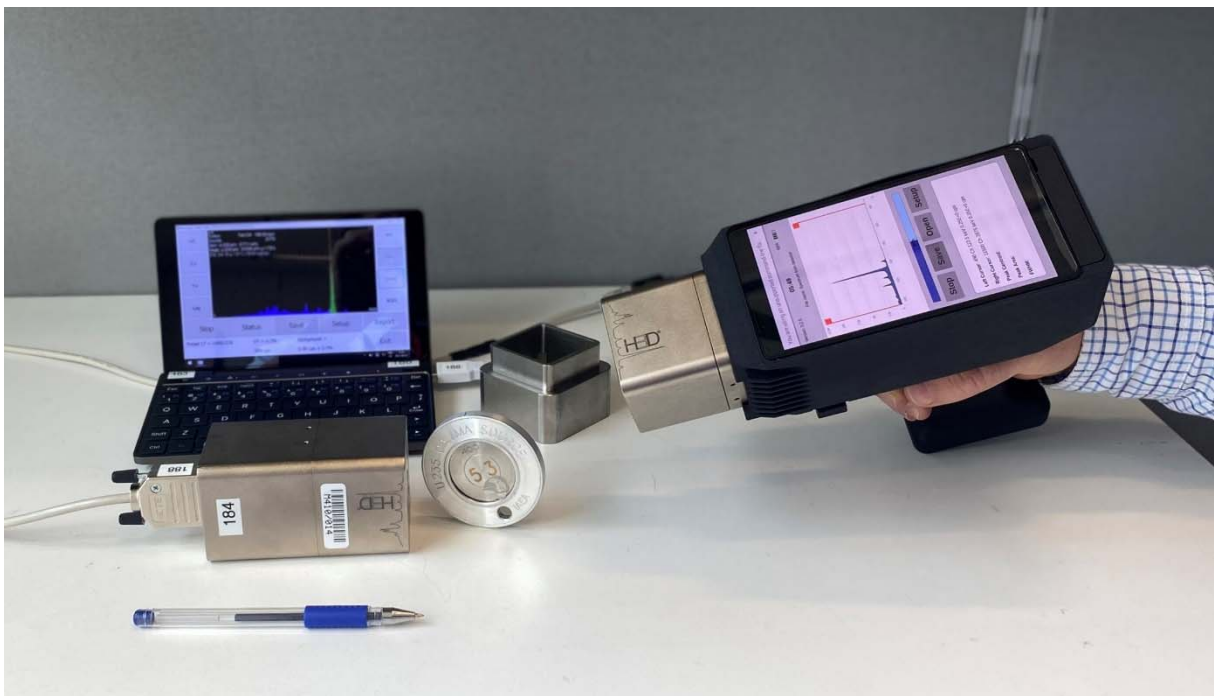
下一代国际原子能机构 \gamma 能谱测量仪：碲化镉锌探测器模块（左） 和手持 \gamma 能谱测量仪（右）。（照片来源：原子能机构）
