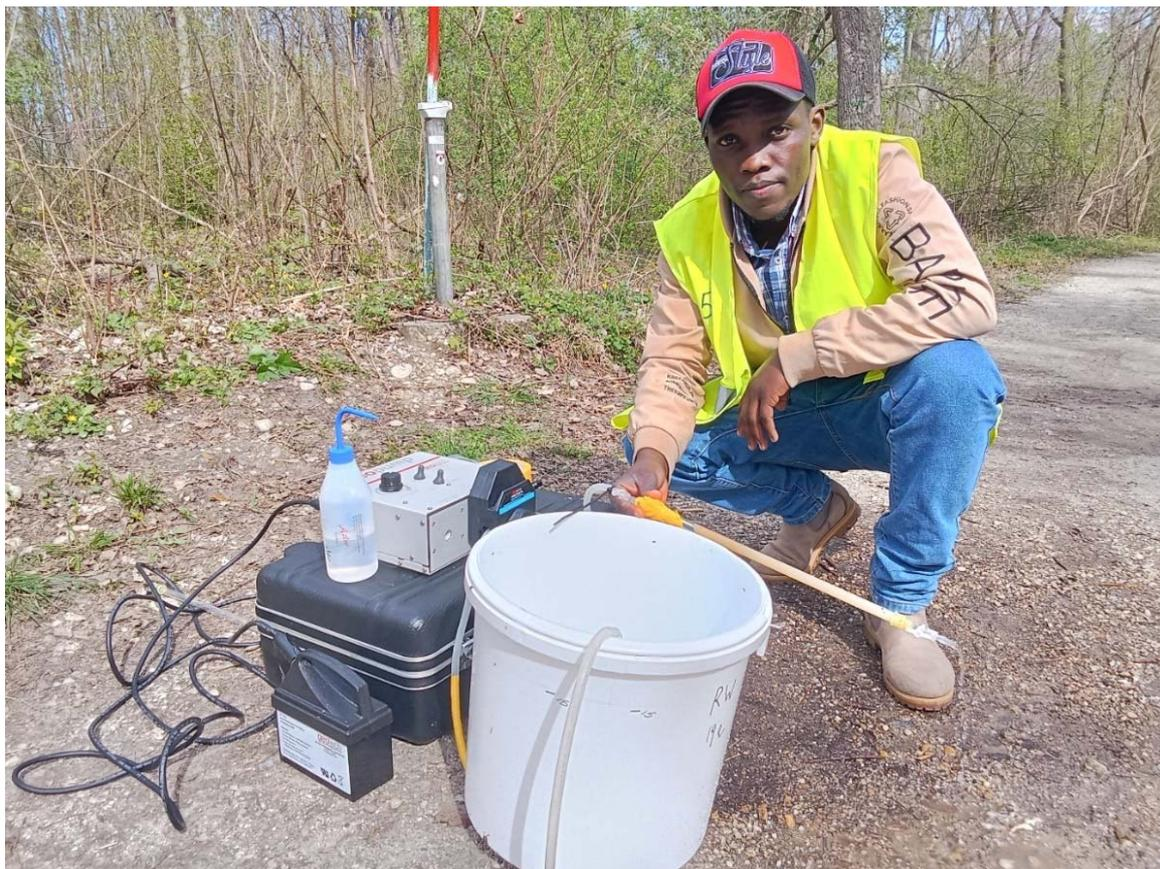
*Fig. B.1. Ensayo de la toma de muestras de agua para analizar el azufre 35 a fin de determinar tiempos de residencia breves en las aguas subterráneas. (Fuente: OIEA)*
