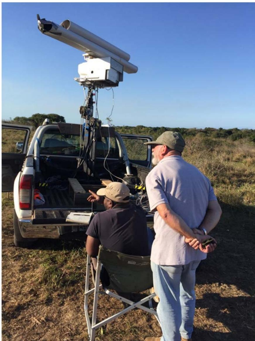
*Fig. B.7. Sistema de radar armónico utilizado en Mozambique para rastrear el vuelo individual de moscas tsetsé. (Fuente: OIEA)*
