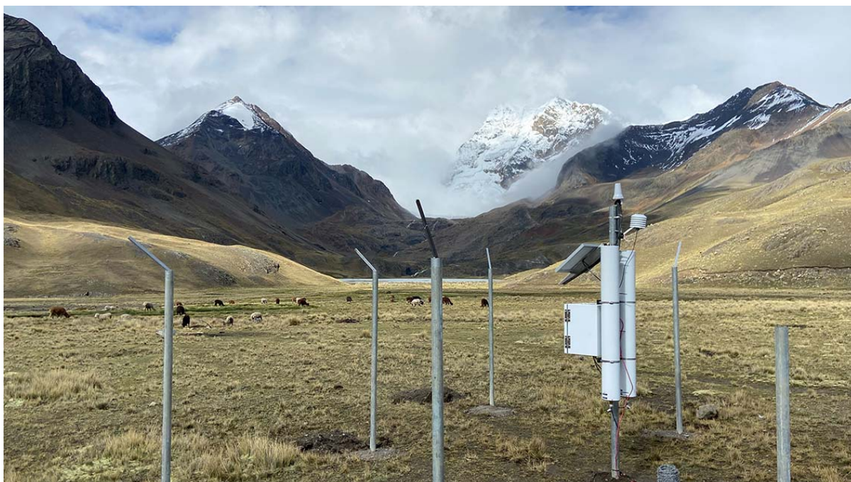
РИС. В.3. Зонд с источником нейтронов космического излучения, установленный в боливийских Андах в высокогорных водно-болотных угодьях, для изучения их роли в удержании воды в условиях изменения климата. (Источник: Трентон Франц)
