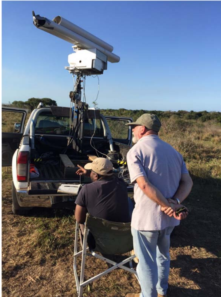
РИС. В.7. Гармоническая радиолокационная система используется в Мозамбике для отслеживания полетов отдельных особей мухи цеце. (Источник: МАГАТЭ)
