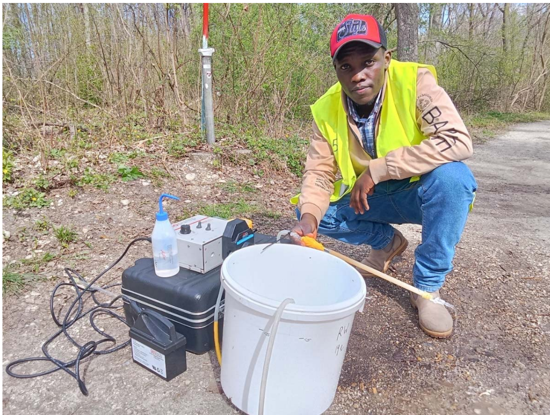
РИС. В.1. Тестирование отобранных проб воды для анализа на содержание серы-35 с целью определения короткого времени пребывания в грунтовых водах. (Источник: МАГАТЭ)
