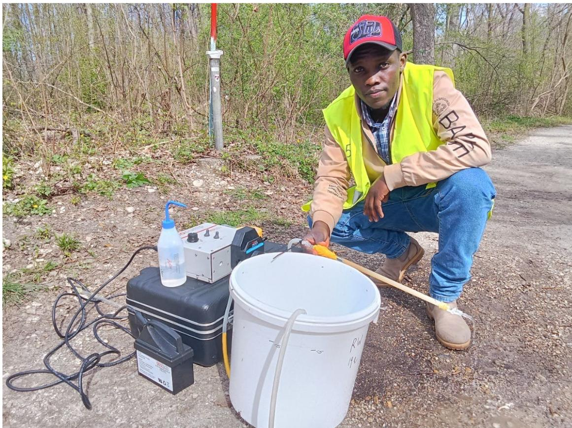
*FIG. B.1. Essai de collecte d'échantillons d'eau à des fins d'analyse du soufre 35 en vue de déterminer sa présence durant de courts temps de séjour dans des eaux souterraines (Source : AIEA)*
