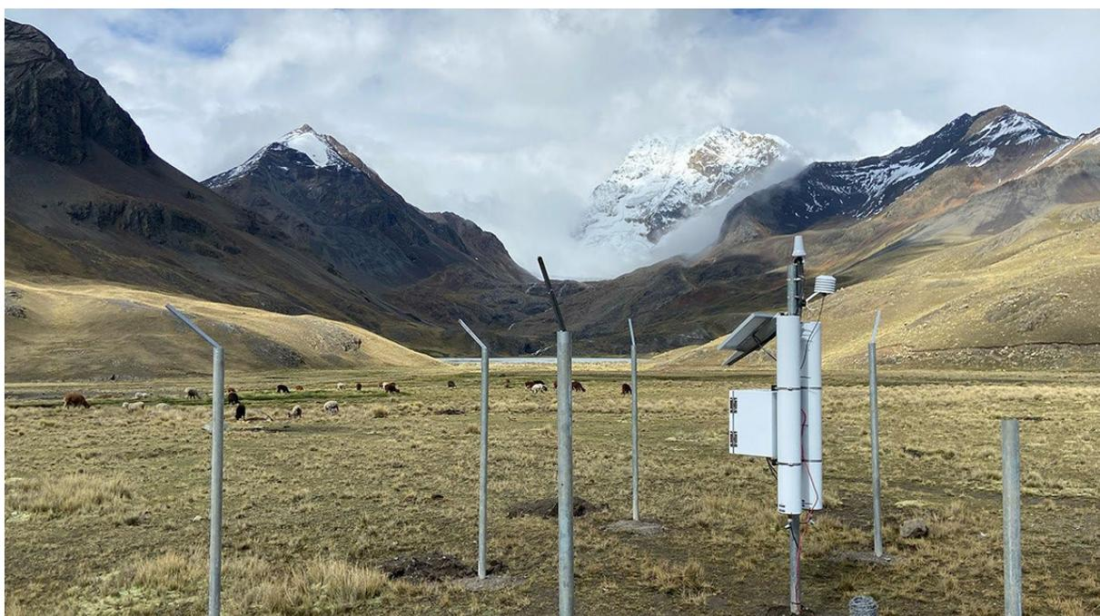
*FIG. B.3. Un humidimètre à neutrons de rayons cosmiques a été installé à haute altitude dans des zones humides des Andes boliviennes afin d'étudier leur capacité de régulation hydrique dans le contexte du changement climatique. (Source : Trenton Franz)*
