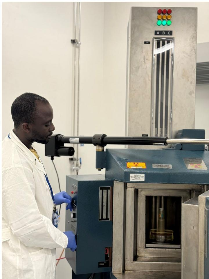
*FIG. B.1. Un étudiant en doctorat du Burkina Faso installe l'irradiateur de modèle 812 destiné à l'exposition des pupes de tsé-tsé. (Source : AIEA)*
