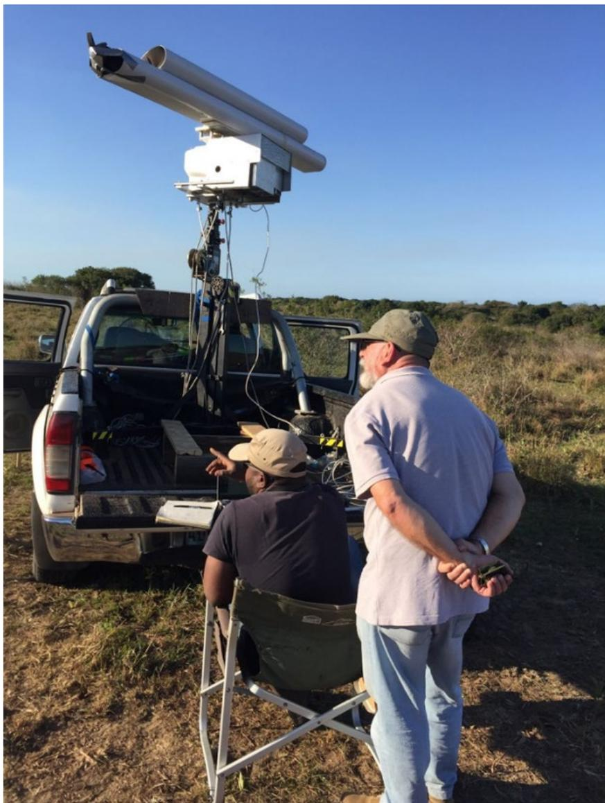
*FIG. B.7. Système de radar harmonique utilisé au Mozambique pour suivre les trajectoires de vol individuelles de mouches tsé-tsé (Source : AIEA)*
