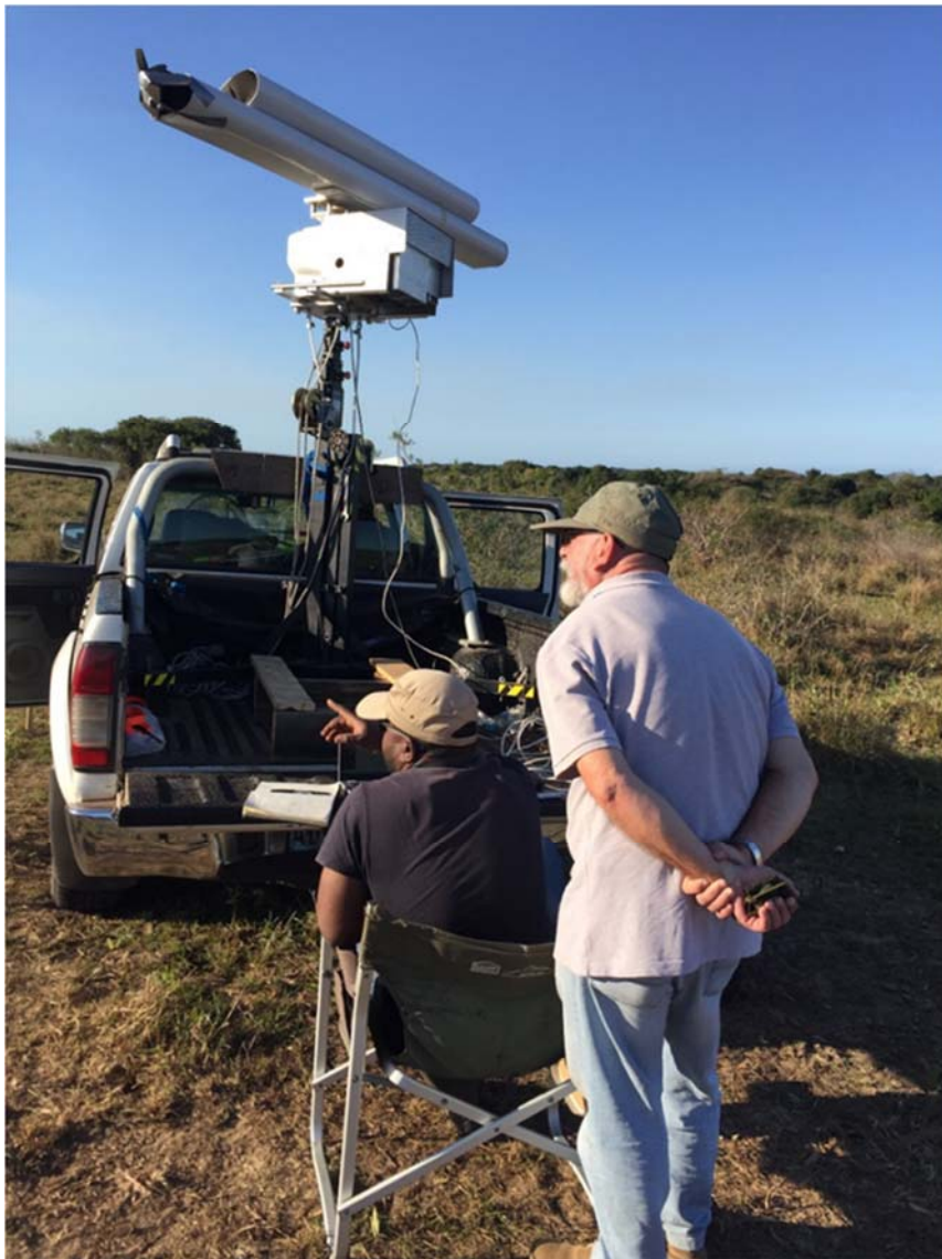
图 B.7. 在莫桑比克使用谐波雷达系统追踪采采蝇的飞行。 (照片来源：原子能机构)
