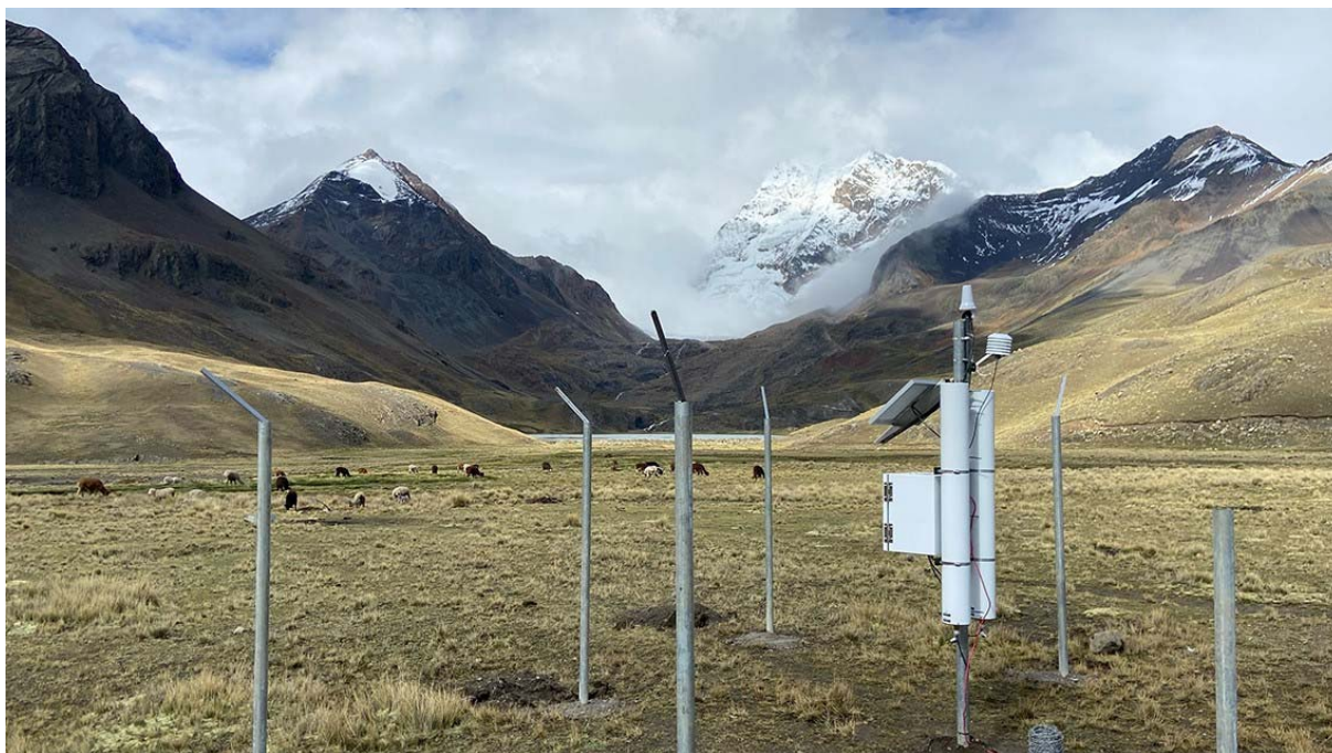
图 B.3. 在玻利维亚安第斯高原湿地安装了一台宇宙射线中子探测器，用于研究气候变化背景下湿地对水的缓冲作用。（照片来源：Trenton Franz）
