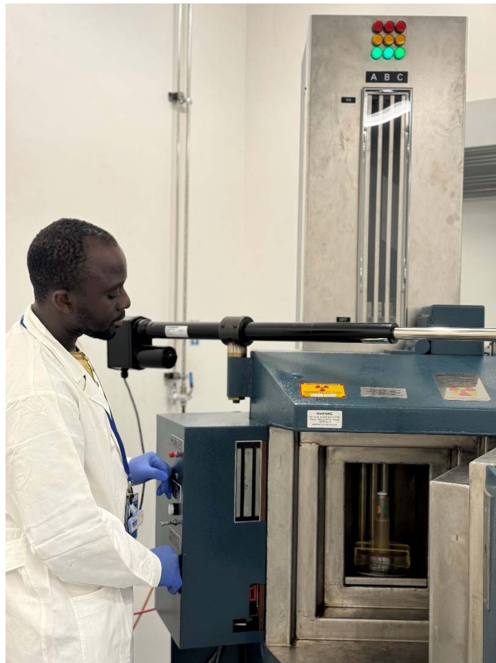
图 B.1. 布基纳法索的一名博士生正在安装 812 型辐照器，以便对采采蝇蛹进行辐照。（照片来源：原子能机构）
