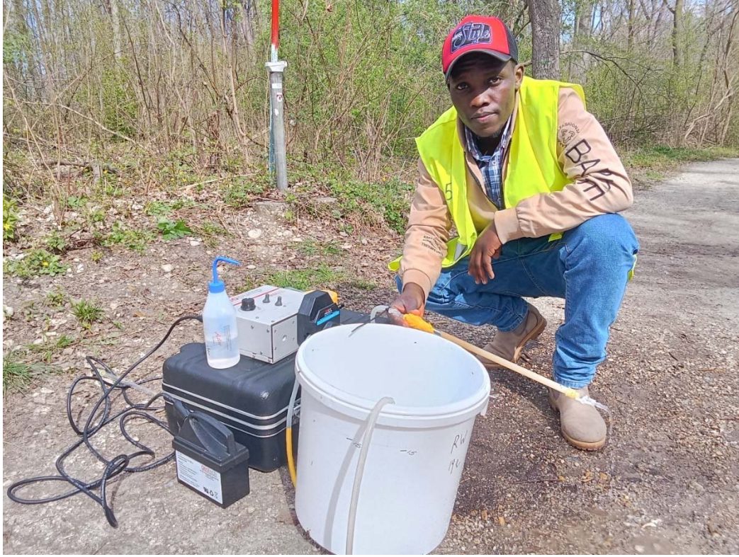
الشكل باء-1- اختبار جمع عينات المياه المستخدمة لتحليل الكبريت-35 من أجل تحديد أزمدة البقاء القصيرة في المياه الجوفية. (المصدر: الوكالة الدولية للطاقة الذرية)
