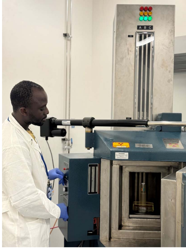
الشكل باء-1- طالب دكتوراه من بوركينافاسو يقوم بإعداد جهاز التشعيع من طراز 812 لتعريض خادرات ذبابة تسي تسي. (المصدر: الوكالة الدولية للطاقة الذرية)
