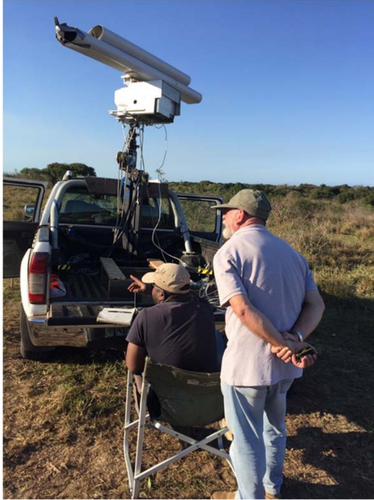
الشكل باء-7- نظام الرادار التوافقي المستخدم في موزامبيق لتتبع طيران الأفراد من ذبابة تسي تسي. (المصدر: الوكالة الدولية للطاقة الذرية)
