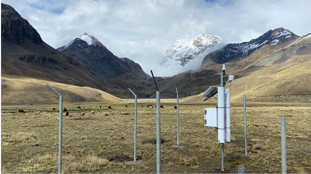
الشكل باء-3- جهاز استشعار نيوتروني للأشعة الكونية تم تركيبه في الأراضي الرطبة من جبال الأنديز في بوليفيا لدراسة دورها في تخزين المياه في سياق تغيّر المناخ (المصدر: تريبتون فرانز)
