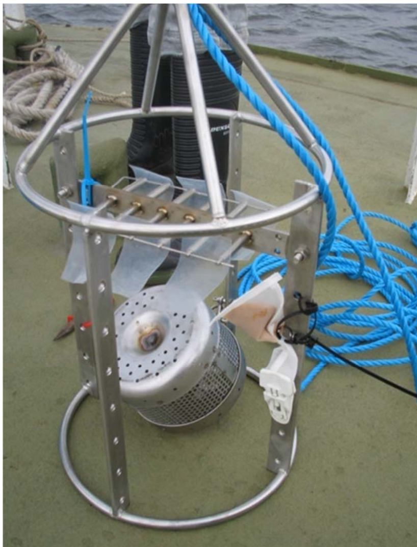
الشكل طاء-2- أجهزة خاملة لأخذ العينات جاهزة للنشر في البحر. (الصورة من: مركز علوم البيئة ومصائد الأسماك وتربية الأحياء المائية، المملكة المتحدة)
