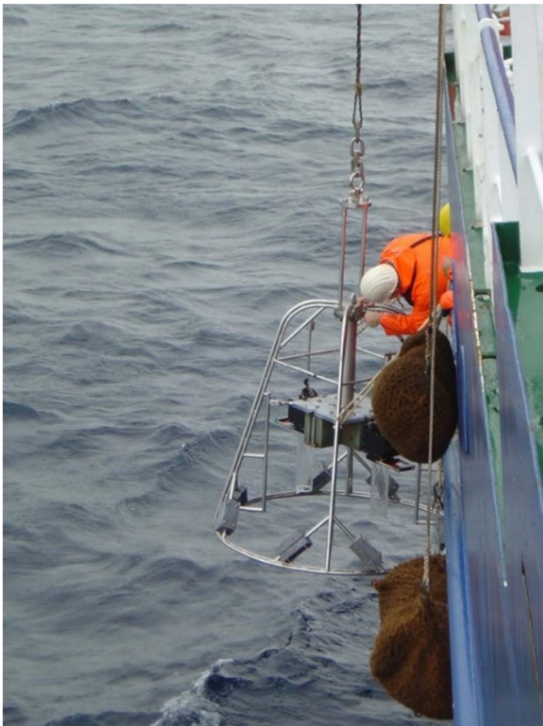
الشكل طاء-4- عملية نشر قاطعة عينات متعددة الأذرع لجمع عينات غير مستثارة من الرواسب لأغراض تحليل الملوثات ودلائل تغير المناخ. وتحفظ الرواسب المعلومات بحسب الترتيب الزمني، وتستخدم المقتنيات الإشعاعية لتحديد تواريخ الأحداث الماضية المدونة في هذه السجلات الطبيعية. (الصورة من: الوكالة الدولية للطاقة الذرية)
