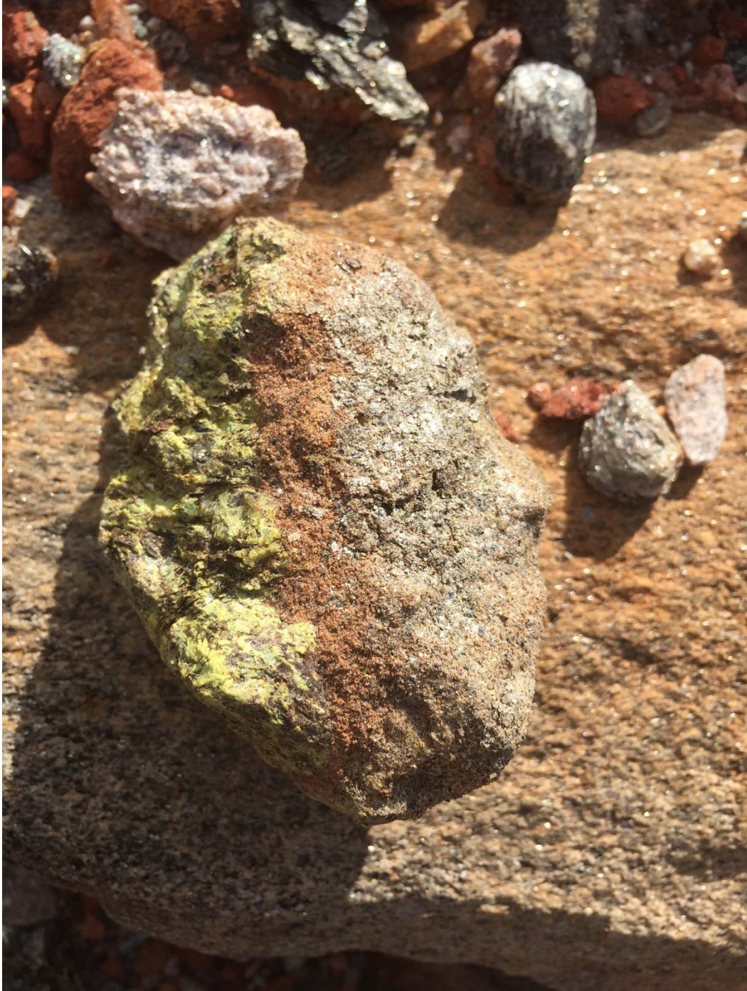
الشكل جيم-3- مخلفات من صناعة تعدين اليورانيوم تحتوي على مواد مشعة موجودة في البيئة الطبيعية.
